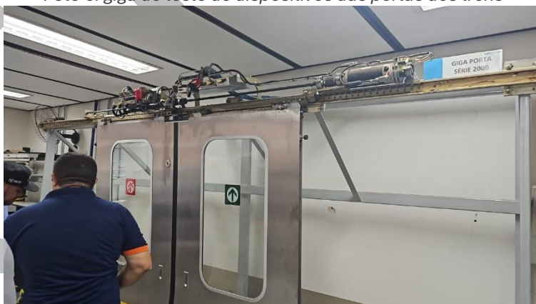
Foto 6: giga de teste de dispositivos das portas dos trens
